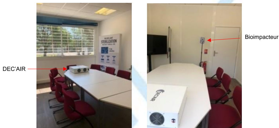
Figure 5: disposition du bio-impacteur et du dispositif de décontamination dans la salle de réunion STERIXENE (45.6m 3 )
